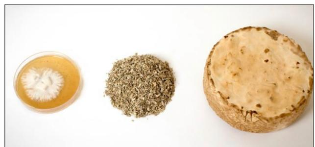
Abbildung 2: Herstellung von Materialien auf Mycelbasis: Eingangs- und Ausgangsmaterialien<sup>8</sup>
